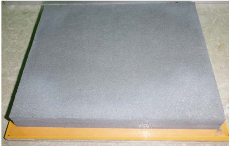
写真 2-8 道路舗装模型
