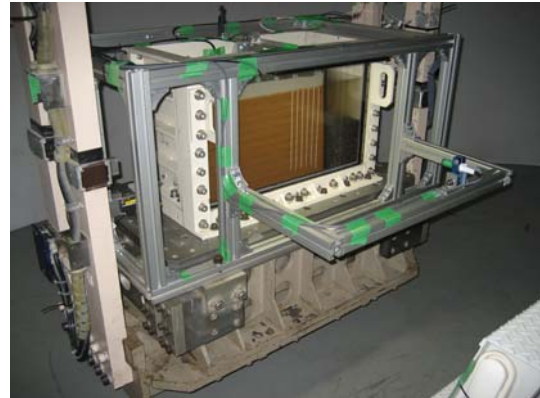
b)剛土槽を用いた振動実験の例
