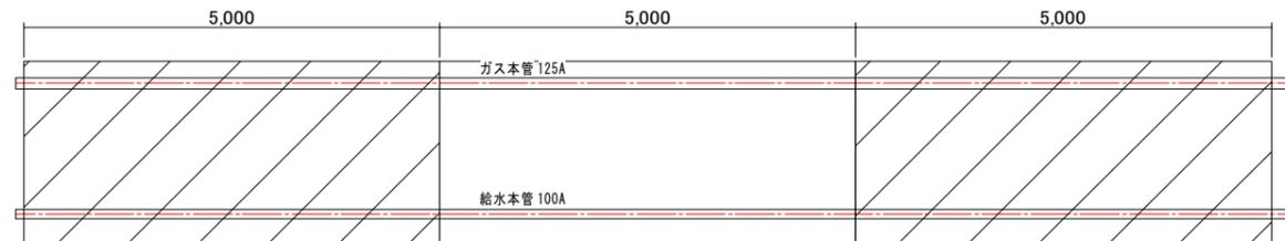
5 m程度毎に掘削し、配管下にシートを通す
