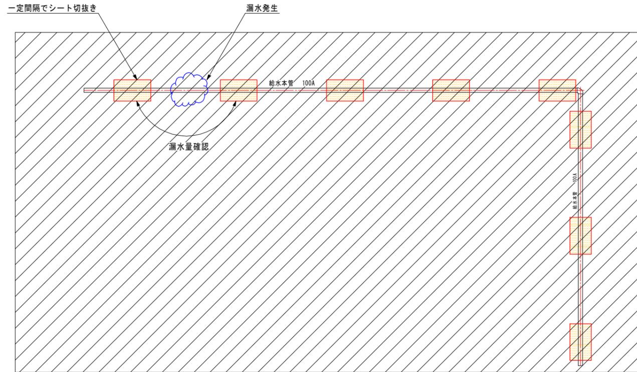
配管直上を一定間隔でシートを切抜く
