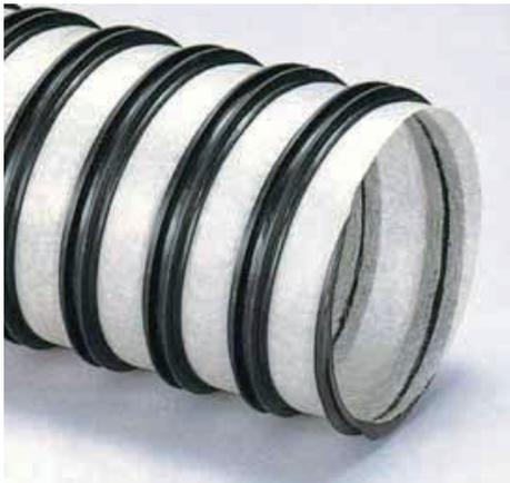
**管体全面から吸水。**—トヨドレンZは、高強度で透水性に優れたポリプロピレンフィルターと補強体で構成。土砂の流入を防ぐと同時に、管体全面からスムーズな吸水効果が得られます。（粗度係数： $n=0.014$ 、透水係数： $1.4 \times 10^{-2} \text{ cm/sec}$ ）
